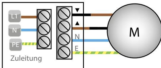
Alle Kabel müssen geschützt und fest verlegt werden. Das Anschlusskabel dabei immer mit einer Schlaufe nach unten verlegen, damit kein Kondenswasser am Kabel entlang fließen und in das Bauteil eindringen kann. Die Kabel während der Montage nicht knicken und so positionieren, dass diese nicht durch bewegliche Teile beschädigt werden können.
